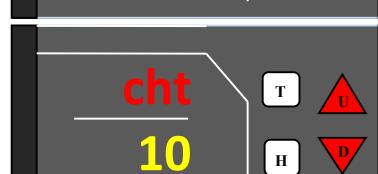
cht: Doba zvlhčování při chlazení (minuty) (pouze pro modely vybavené zvlhčovačem)
