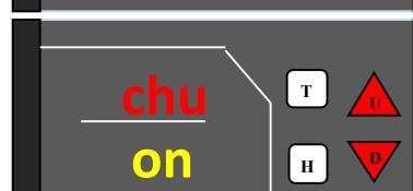
chu: Aktivace zvlhčování během chlazení (pouze pro modely vybavené zvlhčovačem)
