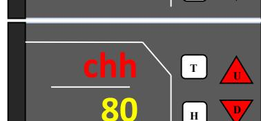
chh: Maximální hodnota vlhkosti nastavená na chlazení (RH%) (pouze pro modely vybavené zvlhčovačem)
